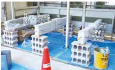
(上) 実験架台を用いた耐震強度の実験
