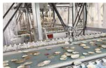
レーザー式ホタテ貝殻穴開けロボットライン
